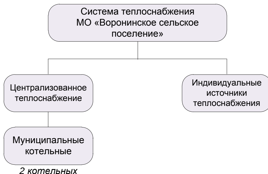
Рис. 1.2. Функциональная структура системы теплоснабжения МО «Воронинское сельское поселение» Томского района Томской области
