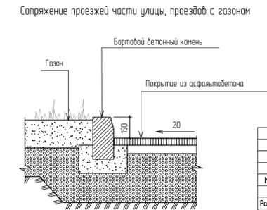
Конструкция дорожного полотна разрабатывается в рабочем проекте, после проведения инженерно-геологических исследований грунтов
